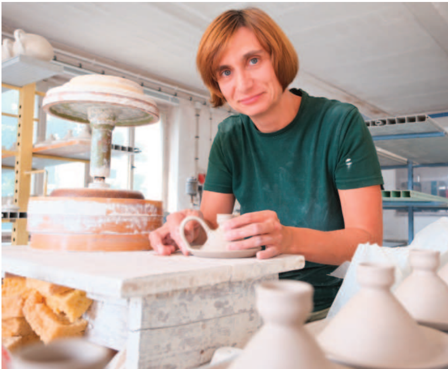
Berit Wolf beim Henkeln eines Kerzenleuchters von Hand. Bei größeren Stückzahlen setzen Kannegießer auf fügelose Technik, das bedeutet die Tasse wird im ganzen inkl. Henkel von Anfang an mit der Tasse produziert. Foto: Daniel Bagehorn
